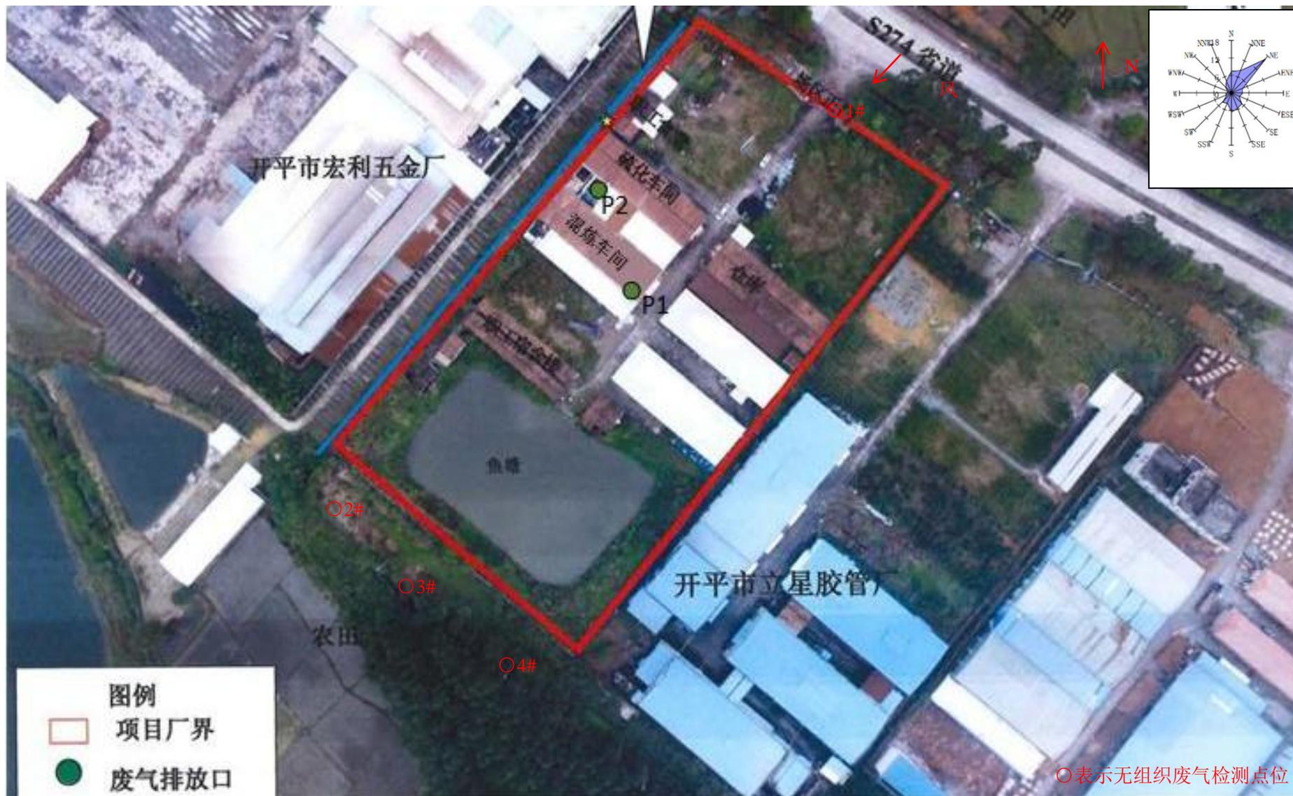
图 2.8-1 废气污染源监测布点图
